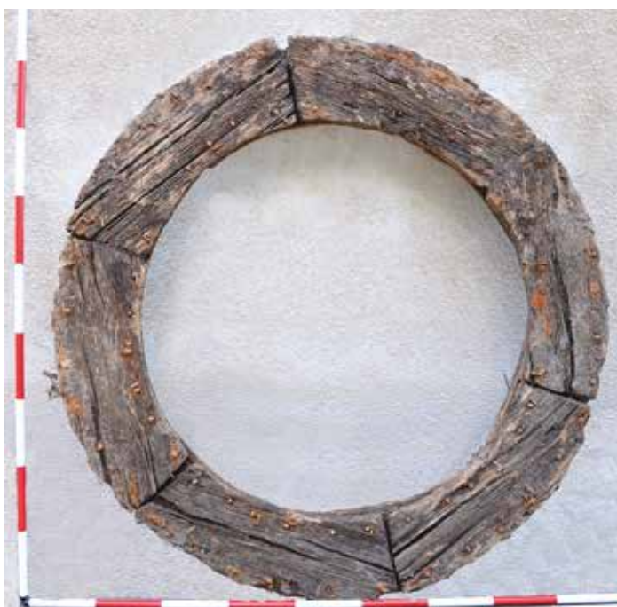
Obr. 22: Dubový základový věnec studny z jižní části zkoumané plochy. Foto T. Blažková, Labrys, o.p.s., 2014; Kresba M. Černý, Labrys, o.p.s., 2014
