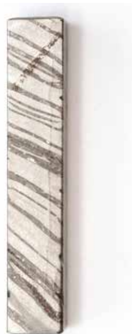
Obr. 2: Vzorek damasku 10 × 15 mm z podeutektoidní oceli a fosforového železa (obsah fosforu 0,5–1 %) po 24hodinové expozici v korozní cele a setření korozních produktů. Foto P. Bárta 2015
