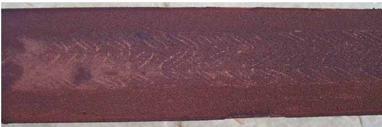
Obr. 3: Detail čepele repliky damaskovaného meče ze 6. století po 12hodinovém pobytu v korozní cele před setřením korozních produktů. Foto P. Bárta 2015
