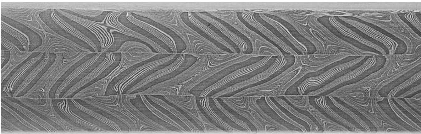
Obr. 4: Detail damaskového vzoru (podeutektoidní ocel a feritické železo s obsahem fosforu cca 0,1–0,3%) čepele repliky damaskovaného meče zvýrazněného expozicí v korozní cele po dobu 48 hodin s následným přeleštěním. Foto P. Bárta 2015
