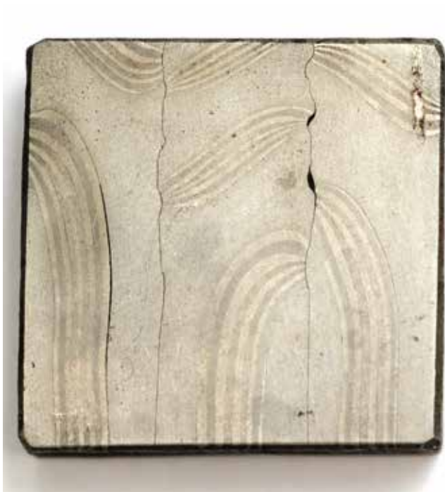
Obr. 1: Vzorek damasku 30 × 30 mm z podeutektoidní oceli a feritického železa po 24hodinové expozici v korozní cele a setření korozních produktů. Foto P. Bárta 2015
