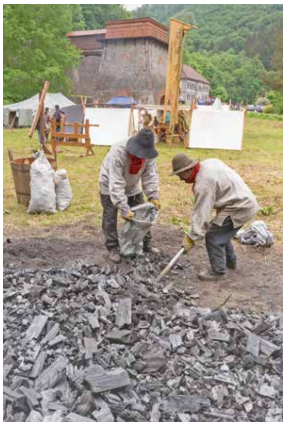
Obr. 3: Během sobotního „Setkání“ je milíř oběma uhlíři rozebrán. Napytlované uhlí je připraveno na další tavby. Foto Martin Barák 2015
