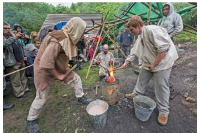
Obr. 12: Kováním se železný kus mění na dřevěném špalku v železnou lupu a následuje pokus o její naseknutí po vzoru našich předků. Foto Martin Barák 2015
