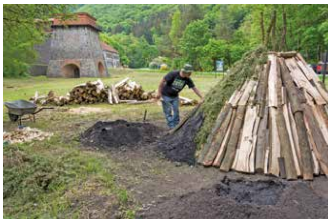
Obr. 1: Stavba milíře, Jiří Kadera zhotovuje vnitřní (tráva) a vnější (mour a hlína) plášť milíře. Foto Martin Barák 2015
