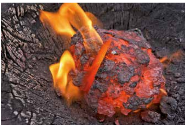
Obr. 13: Detail částečně naseknuté železné lupy o hmotnosti 5,44 kg, výsledku ukázkové tavby. Foto Martin Barák 2015
