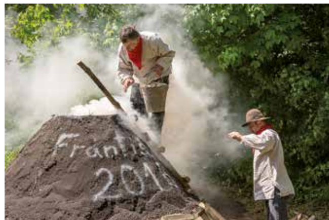
Obr. 2: Krátce po zapálení doplňuje Eduard Tržil za asistence Jiřího Kadera vyhořelý prostor krále v milíři dřívím. Foto Martin Barák 2015
