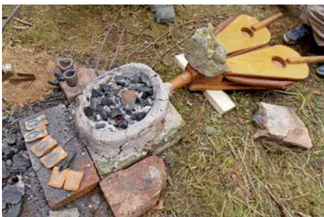
Obr. 7: Michal Daňa předváděl odlévání drobných předmětů z bronzu tradiční technologií. Foto Ondřej Merta 2015
