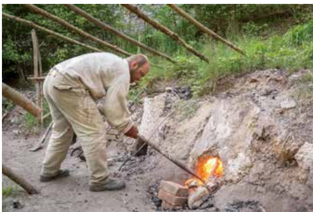
Obr. 11: Měchy jsou odstaveny a Domik Talla vylamuje štítek pece s tenkou hrudí (v naší „huti“ pec č. 3). Následovat bude vynětí železné houby. Foto Martin Barák 2015
