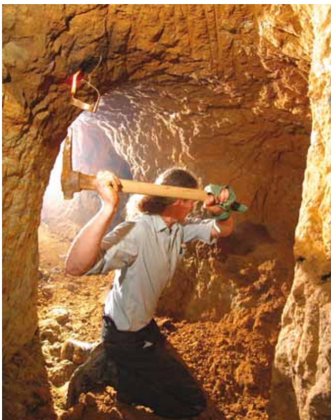
Obr. 6: Zahájení experimentální ražby v dole Boris. Foto K. Šmehil
