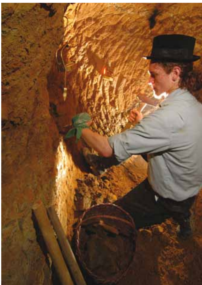
Obr. 7: Lámání rudy klíny v dole Boris. Foto K. Šmehil
