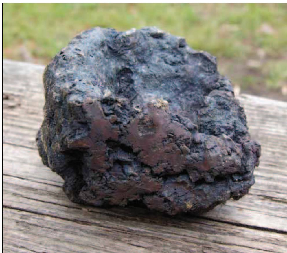
Obr. 5. Hrubě kovaný kus JK-08-01 o hmotnosti 1,55 kg.
