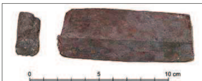
Obr. 8. Polotovar JK-08-02 z něhož byl odseknut vzorek (vlevo) pro metalografické šetření.
