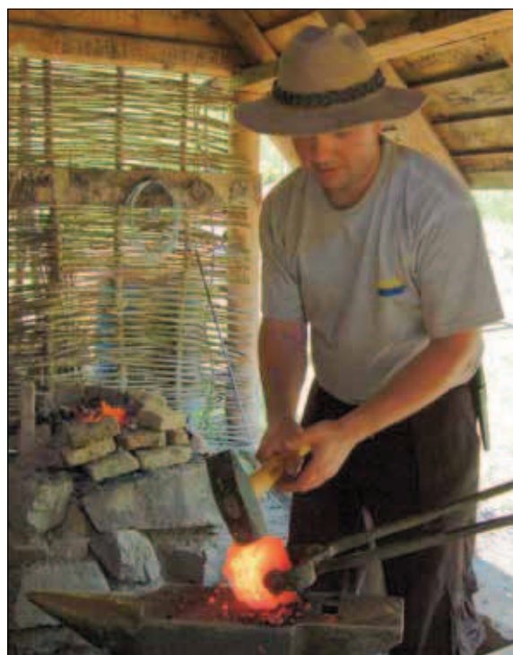
Obr. 4. Kování železné houby.
