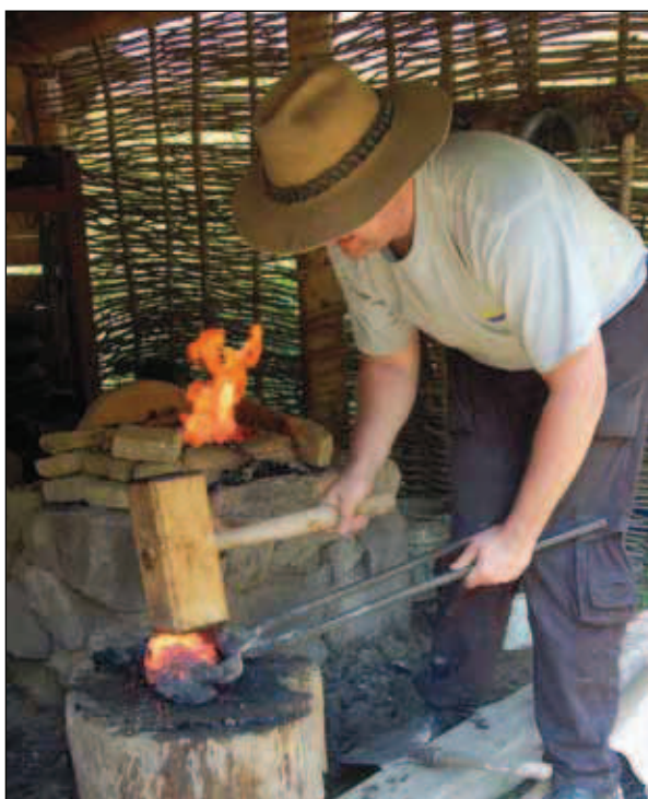
Obr. 3. Hrubé otlučení strusky dřevěnou palicí.
