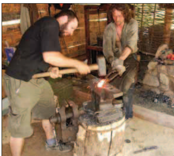
Obr. 6. Další fáze homogenizace železné houby.
