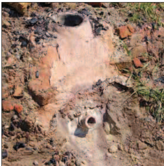
Obr. 1. Stará huť u Adamova, rekonstrukce raně středověké kusové železářské pece s tenkou hrudí, v níž byl vyroben pojednávaný polotovár. Pec je připravena k otevření (vylomení) po ukončení experimentální tavby.
