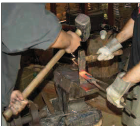
Obr. 7. Odseknutí vzorku určeného k metalografickým rozborům.
