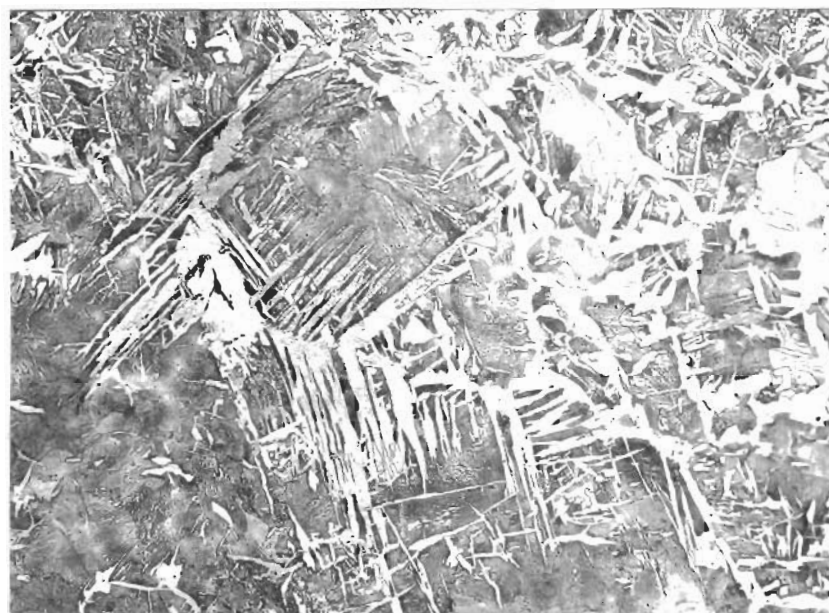
Obr. 5 Perliticko-feritická struktura vzorku M s vyloučením feritu podle Widmannstätena. Leptáno nitalem, zvětšeno 200x.
