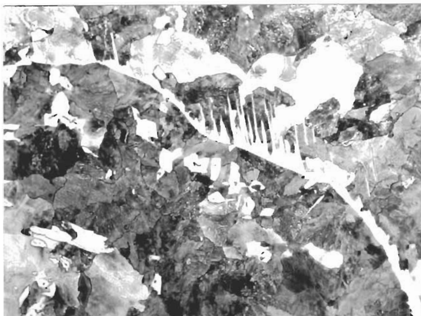
Obr. 4 Perlitická struktura vzorku K se sifovým feritu po hranicích původních austenitických zrn. Leptáno nitalem, zvětšeno 200x.
