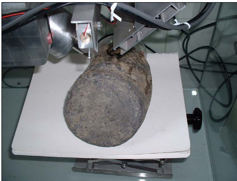
Obr. 5 Vnější strana dna a stěny tyglíku se značkou pod detektorem přístroje (Brno NS 5A). Povrch nese šedo-zelenou sklovinu obsahující Zn
