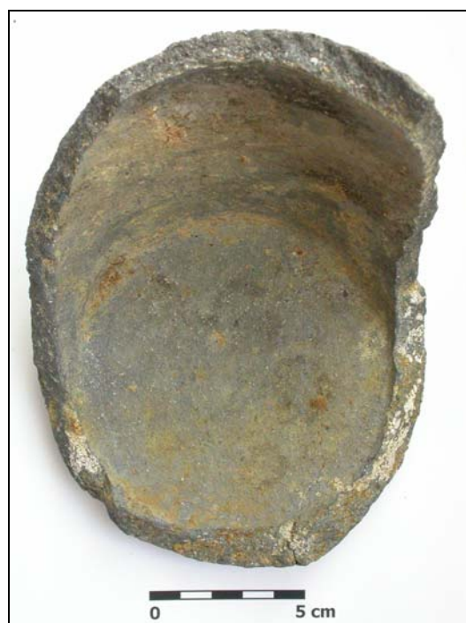
Obr. 6 Vnitřní strana dna a stěny tyglíku (Brno NS 5B) se stopami Cu, Ag
