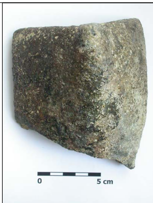
Obr. 3 Výlevka tyglíku (Brno NS 3) s hnědozelenou sklovinou obsahující Cu
