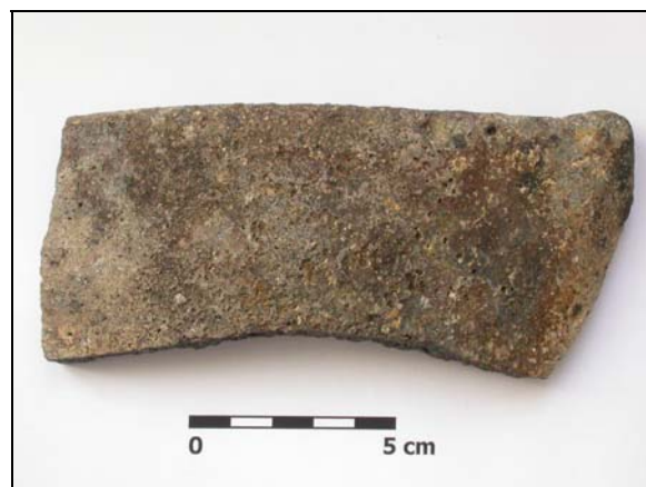
Obr. 2 Stěna tyglíku (Brno NS 2) se zelenými krustami obsahující Ag, Cu
