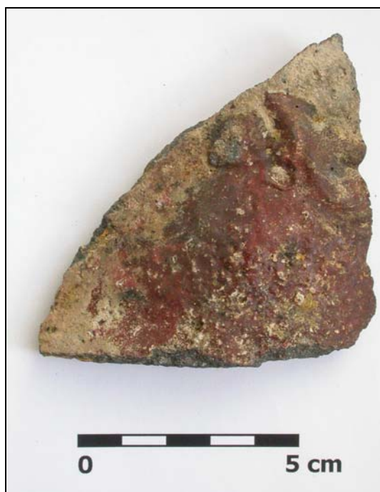
Obr. 1 Zlomek tyglíku (Brno NS 1) s červenou sklovinou obsahující Au, Ag, Cu
