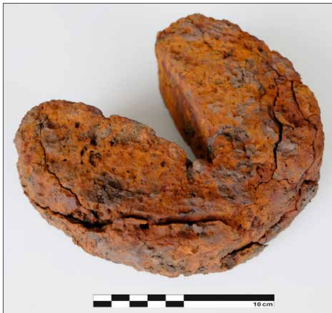
Obr. 19: Lupa Mikulčice 1 je největší a nehmotnější ze zatím nalezených lup se zásekem (4 480 g). Na fotografii je zachycena spodní strana lupy, na horní je opět miskovitá prohlubeň. Viditelná je ploška vzniklá při nasekávání a odlupující se okrajové partie (foto: Ondřej Merta)
