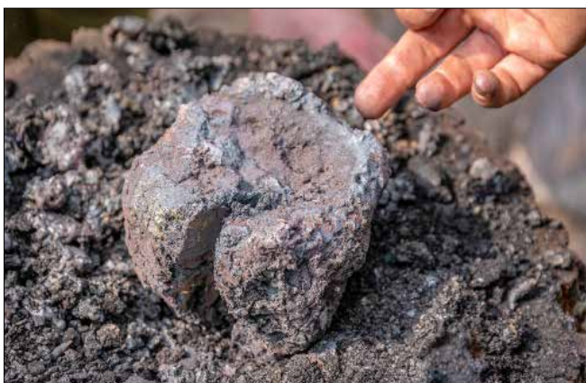
Obr. 3: Lupa vzniklá při experimentální tavně v replice raně středověké kusové pece v areálu Staré huti u Adamova v květnu 2019. Fotografie zachycuje stav po kování lupy dřevěnou palicí a poté kladivem na dřevěném špalku. Okolo se nachází oklepaná struska a okrajové části železného kusu, které se nepodařilo spojit s lupou. Je pravděpodobné, že kovové části by byly použity při další tavně. Na horní straně lupy je viditelná miskovitá prohlubeň vytvořená proudem dmýchaného vzduchu (foto: Martin Barák)
