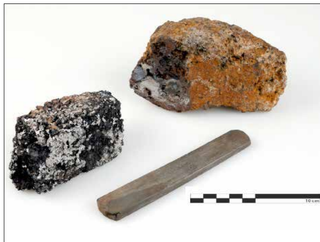
Obr. 12: Polovina lupy nalezené u Starých Zámek u Líšně byla kovářsky zpracována. Vlevo zhruba vykováný kus o hmotnosti 760 g, vpravo dalším kováním již zcela vyčištěný a homogenizovaný kus o hmotnosti 160 g. Vzadu dochovaná polovina o hmotnosti 1 454 g (foto: Eva Řezáčová)
