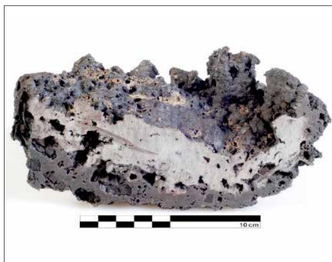
Obr. 2: Na řezu železnou houbou z experimentu v roce 2004 je viditelná přítomnost partií homogenního kovu, vnitřních pórů, strusky i uhlíků (foto: Eva Řezáčová)
