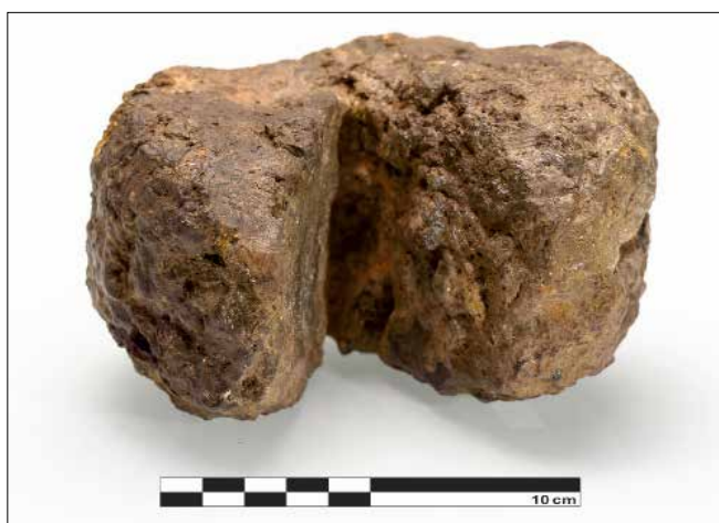
Obr. 7: Lupa Olomučany 1, pohled dovnitř záseku. Je viditelný rozdíl v obou plochách záseku – plocha na fotografii vlevo je hladká, plocha vpravo nikolí. Snad se jedná o následek držení nástroje (foto: Martin Barák)
