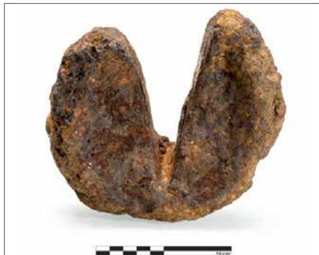
Obr. 16: Lupa Klášťov 4 má kompaktní povrch a viditelnou plošku vzniklou tlakem na podložku při natínání. Nástroj sloužící k rozetnutí lupy neprošel přes celou výšku lupy a byl držen šikmo k rovině lupy – asi malý hutník (foto Martin: Barák)
