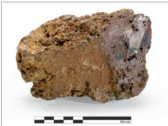
Obr. 11: Polovina železné lupy nalezené v bezprostřední blízkosti hradiska Staré Zámky u Líšně. Lupa byla rozdělena a jedna její polovice kovářsky zpracována. V horní části je viditelná miskovitá prohlubeň ukazující polohu železného kusu v peci. Dobře viditelný je málo kompaktní povrch, plocha záseku a nerovnoměrné rozložení vnitřních pórů (foto: Martin Barák)
