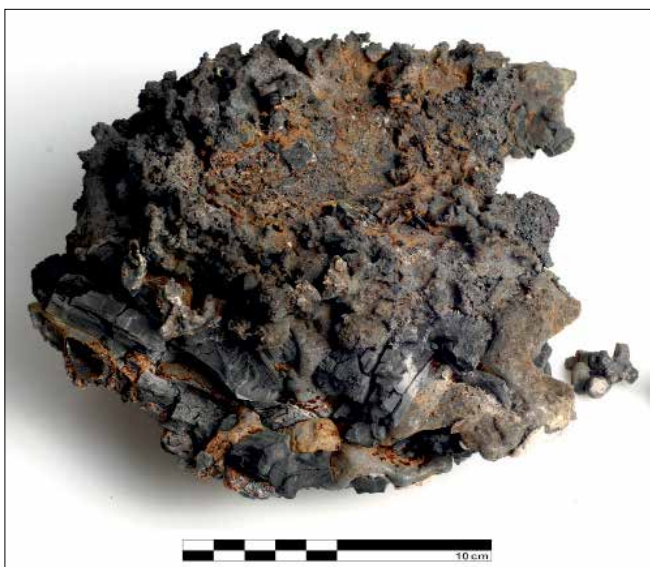
Obr. 1: Železná houba získaná při experimentální tavně v replice raně středověké kusové železářské pece ve Staré huti u Adamova v roce 2008. Dobře patrná je přítomnost velkého množství strusky a dřevěného uhlí i vzhled podobný mořské houbě, který dal tomuto typu železářského polotovaru název (foto: Eva Řezáčová)
