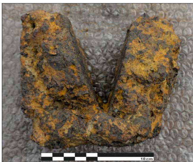
Obr. 22: Naseknutá lupa z Horduše-Hámrov je mezi ostatními neobvyklá svým „hranatým“ vzhledem. Při nasekávání vznikla nejen výrazná plocha, ale došlo i k deformaci hmoty lupy. Vlevo je patrná další rovná plocha jako důsledek homogenizace zřejmě nepřilíživých hustých lup (foto: Richard Kaňa)
