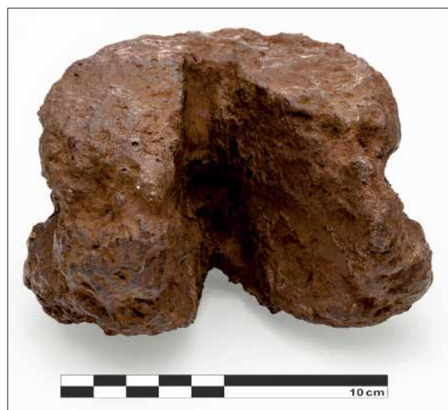
Obr. 8: Kopie lupy Olomučany 2 zachycuje stav objektu před rozřezáním pro účely metalografického průzkumu, pohled dovnitř záseku. Sbírkový fond Technického muzea v Brně (foto: Martin Barák)
