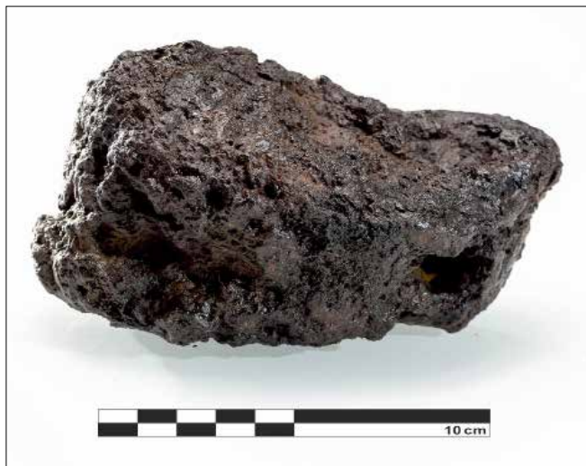
Obr. 15: Polovina lupy Klášťov 3. Plocha záseku je na odvrácené straně lupy. Můžeme vidět členitý povrch i miskovitou prohlubeň (foto: Martin Barák)
