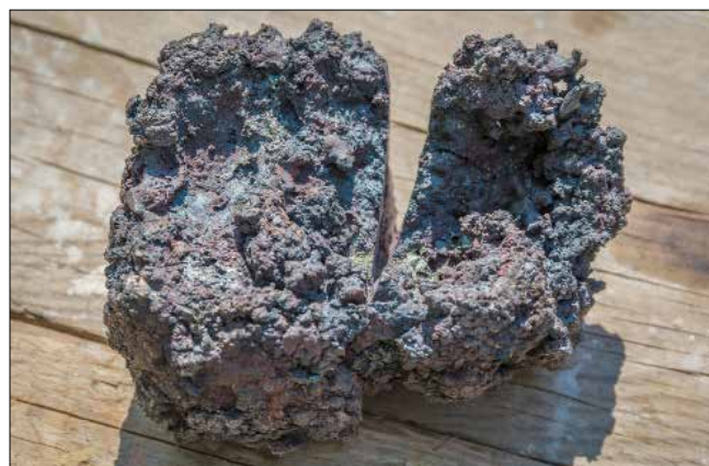
Obr. 4: Výsledek experimentální tavně v replice raně středověké kusové železářské pece v areálu Staré huti u Adamova (květen 2018), železná lupa naseknutá sekerou. Ve srovnání se záseky v archeologických lupách je tento výrazně užší. I zde můžeme pozorovat miskovitou prohlubeň. Ve srovnání s lupou na obr. 3 je méně kompaktní – její okrajové části byly méně kovány. Oproti většině archeologických lup je povrch velmi členitý – jak by vypadal po 1100 letech v zemi? (foto: Martin Barák)
