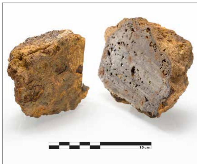
Obr. 10: Současný stav lupy Olomučany 2 podrobené metalografickému průřezu. Na ploše řezu je viditelná čistota kovu i nevelké množství pórů. Lupa se nachází v archeologické expozici Muzea Blanenska (foto: Martin Barák)
