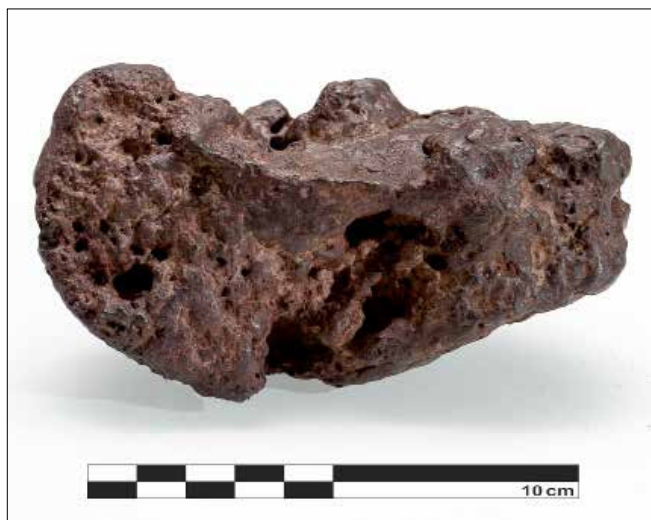
Obr. 13: Polovina železné lupy Klášťov 1 tvořila součást prvního nalezeného depotu. Pohled na plochu záseku (směřujícího zprava). Patrné je velké množství dutin. Zbarvení je dáno konzervátorských zásahem nálezce (foto: Martin Barák)
