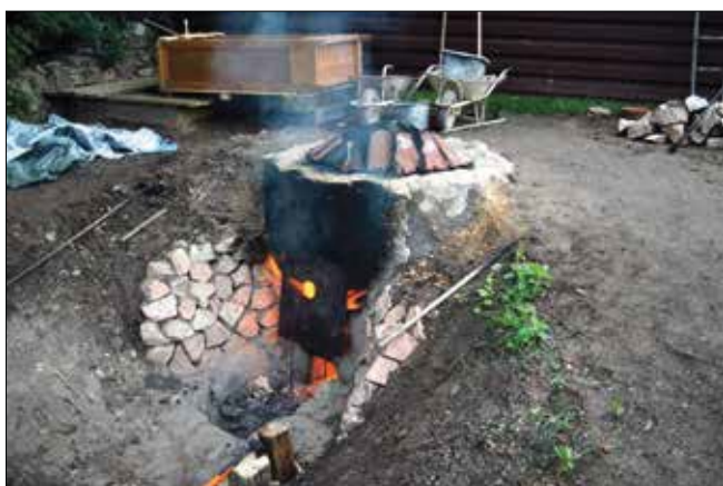
Obr. 2: Kostelec nad Černými lesy, září 2018. Pec v provozu po obložení vrcholu vsázky pálenými taškami (foto Petr Kos)
