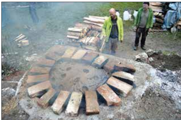
Obr. 5: Stará huť u Adamova. Regulační obklad pálenými cihlami nad vysušenou vsázkou (foto P. Kos)
