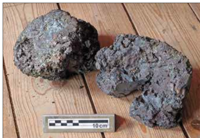
Obr. 3: Dvojice železných lup vyrobených v pátek 25. května 2018. Vlevo lup z pece č. 1 o hmotnosti 5,4 kg (mělký zásek není vidět), vpravo lup z pece č. 2 o hmotnosti 4,2 kg. Při obou tavnách bylo použito 15 kg shodné železné rudy (foto Ondřej Merta)
