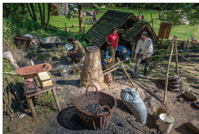
Obr. 1: Stará huť u Adamova, 27. května 2018. Uprostřed šachtová železářská pec obsluhovaná Ivanem Hrovatinem a Tajanou Sekelj Ivančan. Zcela vlevo patrna „maďarská“ pec, pro niž připravuje Mark Haramza novou dyznu
